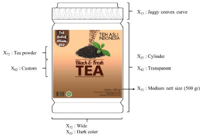
Figura 14 · Representación 2D del diseño de la forma de empaquetado. Fuente · (Djatna & Kurniati, 2015).
