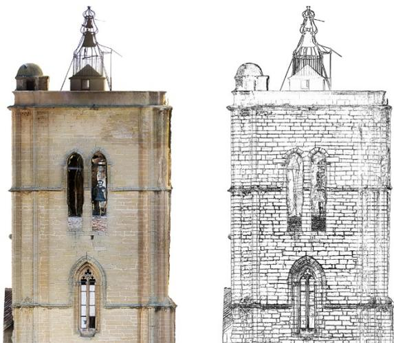
Figura 4: Creación de alzados mediante filtros de imagen.
