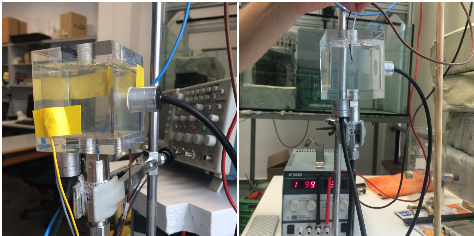
Figura IV.45. Montaje experimental para la generación de un pulso termoacústico semejante al del crecimiento de burbuja en la caja de MODA-LS.
