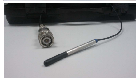
Figura III.30. Transductores piezoeléctricos utilizados como referencia en todas las medidas de calibración de transductores.
