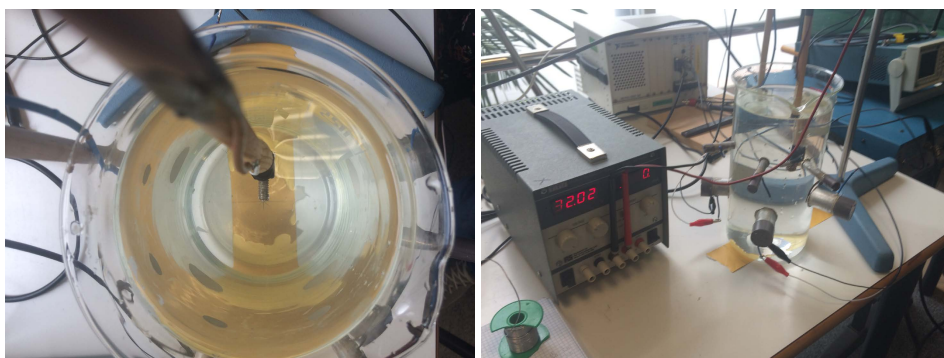
Figura IV.42. Montaje experimental para la generación de un pulso termoacústico semejante al del crecimiento de burbuja en la vasija de calibración
