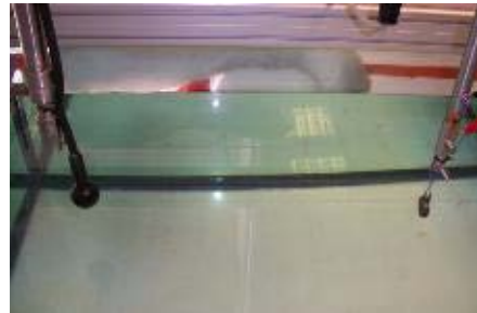
Figura II.2. A la izquierda, esquema del montaje experimental en el tanque de agua para testear la propagación acústica. A la derecha, fotografía de una de las medidas.
