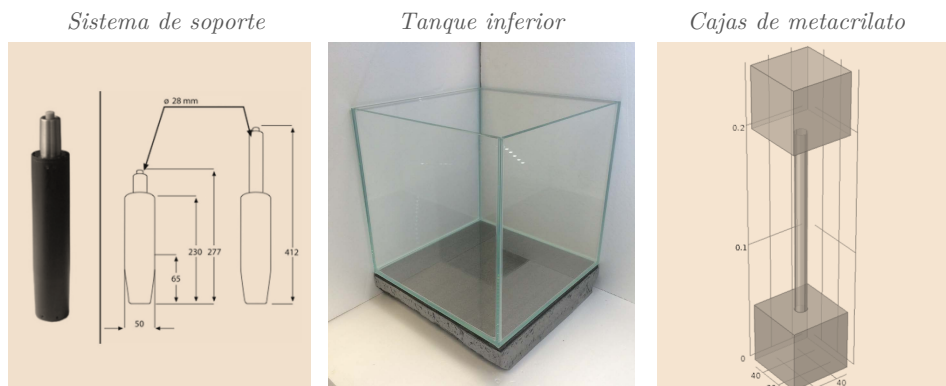
Figura V.6. Componentes principales de la parte inferior del detector. A la izquierda, muelle hidráulico para desplazar verticalmente y ajustar el tanque inferior. Al centro, tanque para el refrigerante con la cámara inferior. A la derecha, diseño de caja de metacrilato unida a tubo cilíndrico para conexión con la caja superior.
