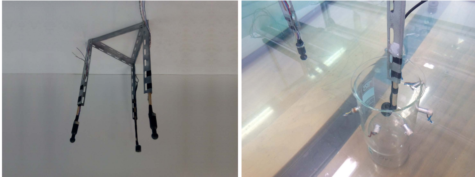
Figura III.74. Configuración del banco de pruebas acústico de Gandia. A la izquierda, instalación de uno de los transmisores FFRx60 y los dos sensores AR190XS en el triángulo de calibración. A la derecha, medida de la señal recibida de emitir dentro de la vasija de calibración de borosilicato.
