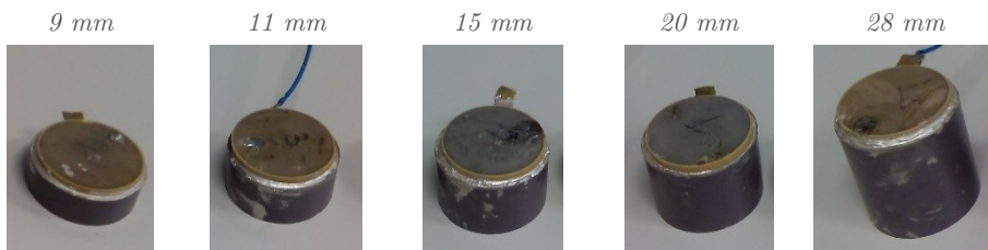
Figura III.54. Distintos espesores de backings pegados a las cerámicas tipo disco.
