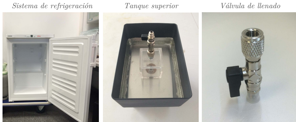
Figura V.5. Componentes principales de la parte superior del detector. A la izquierda, el sistema de refrigeración, que se situará a 1m de altura aproximadamente. Al centro, recinto para el fluido refrigerante con la cámara superior (imagen del BPA, con ligeras modificaciones para MODA-LS). A la derecha, Válvula de llenado del detector.
