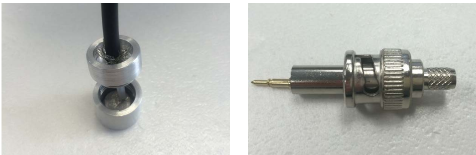
Figura III.82. Detalle del apantallamiento del cable haciendo contacto con el encapsulado y conector BNC.
