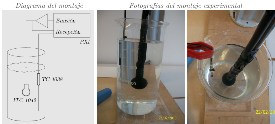
Figura II.6. Esquema del montaje experimental para la propagación acústica en el interior de la vasija llena de agua y fotografías de una de las medidas.
