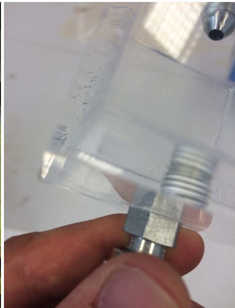
Figura II.83. Microfisuras en la junta entre las paredes previo a presurización (izquierda) y fisuras en el contacto con el conector metálico superior (derecha).
