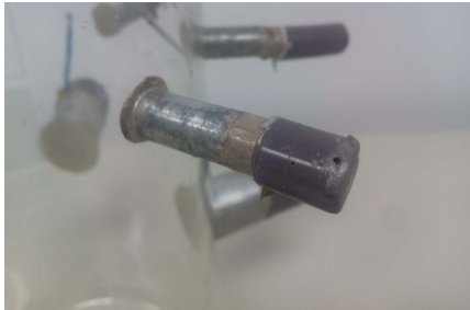
Figura III.64. Ejemplos de cerámicas pegadas con ML y BK.
