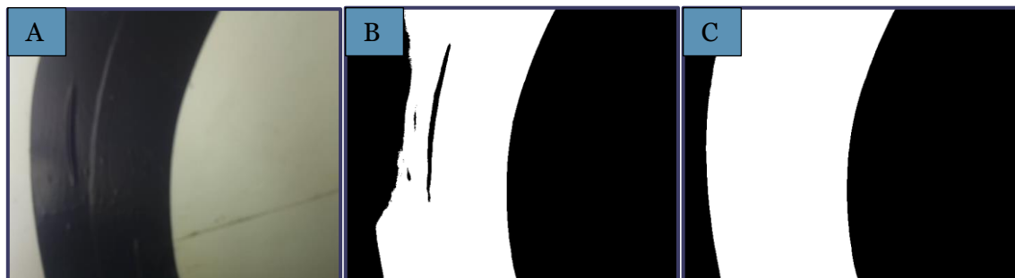
Figura 6.2 Umbralización simple VS Otsu en iluminación no uniforme
