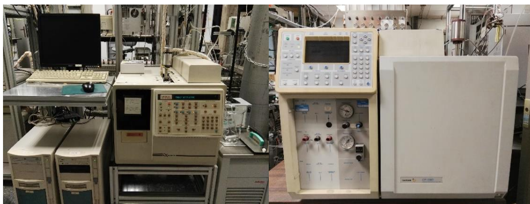
Figura 3.2 Sistemas de análisis cromatográfico (GC1: izquierdo, GC2: derecho).
