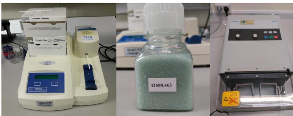
**Figura 3.2.** Micro osmómetro (izquierda), microesferas de vidrio (centro) y homogeneizador/agitador (derecha).
