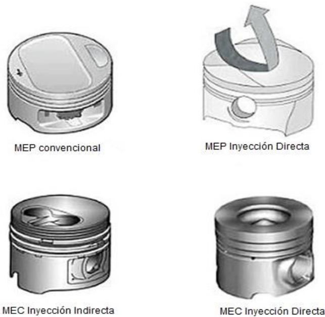
Figura 2-3 Geometría de pistones según el tipo de motor
