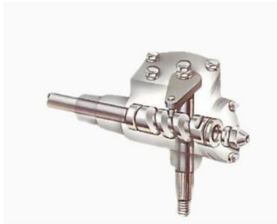
Fig.5.31 Interior de la caja de una dirección de tornillo sinfín. Ref. [13]
