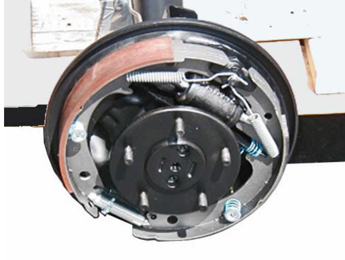
Fig.5.36 Imagen detallada de unos frenos de tambor. Ref. [16]
