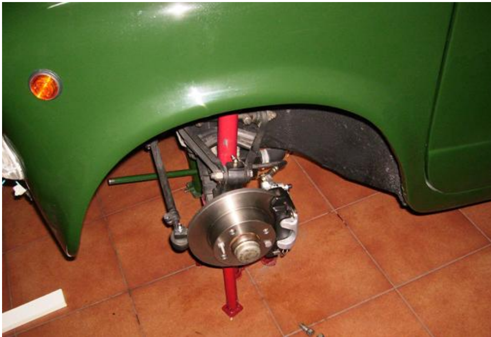
Fig.5.35 Frenos de disco pertenecientes a un modelo de Seat 600. Ref. [15]
