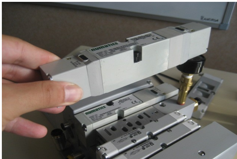
Fig. 5.14, 5.15 i 5.16 – Incompatibilitat de les electrovàlvules amb regulador de pressió Parker
