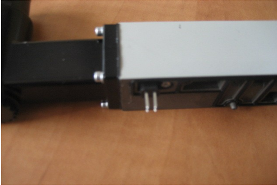
Fig. 5.3 – Connexió M12 del regulador de pressió Numatics
