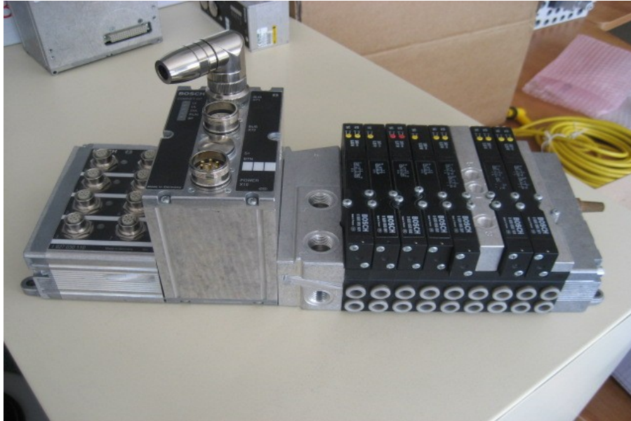
Fig. 1.2 – Illa de distribució HF03 Bosch-Rexroth
