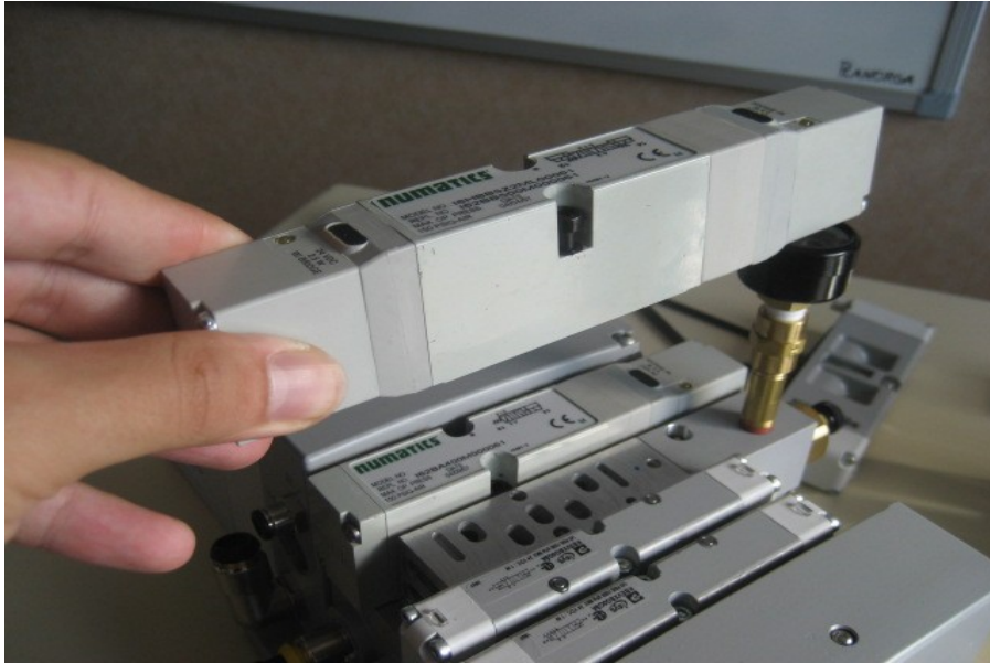
Fig. 5.17 – Compatibilitat de les electrovàlvules BOSCH-Rexroth amb reguladors Parker
