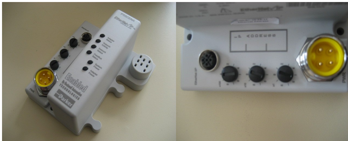
Fig. 5.24 – Mòdul Ethernet/IP de Parker i detall de la connexió
