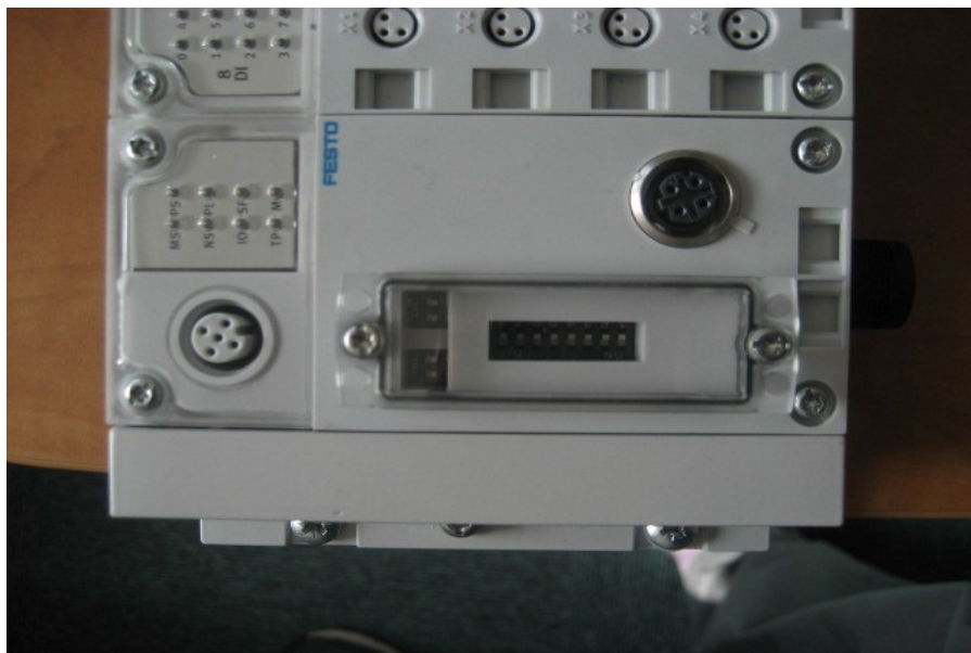
Fig. 5.20 – Connexions del mòdul Ethernet/IP de FESTO
