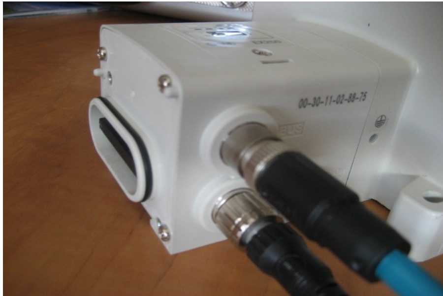
Fig. 5.22 – Mòdul EX250 cablejat i assemblet a l'illa
