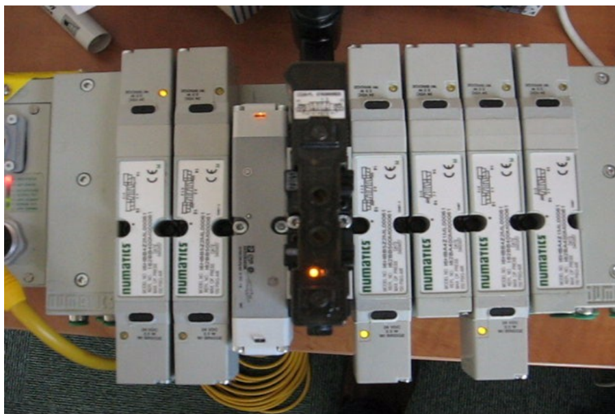
Fig. 5.26 – Il.luminació de les bobines imparelles
