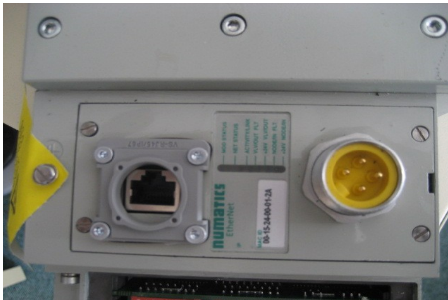
Fig. 5.19 – Connexions del mòdul Ethernet/IP de Numatics
