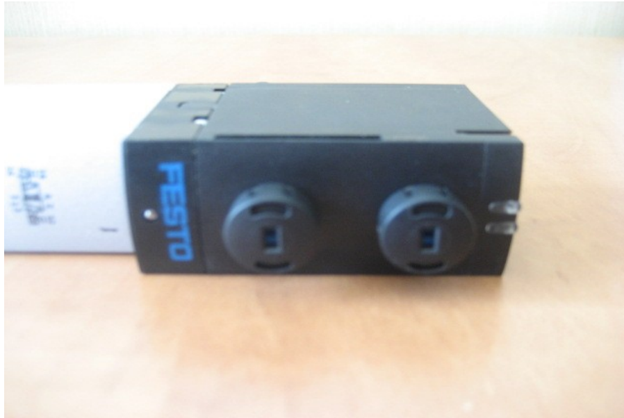
Fig. 5.5 – Comandaments manuals i LEDs del distribuïdor FESTO
