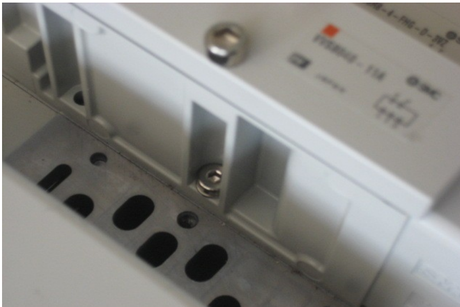
Fig. 5.10 – Cargol entre embase i regulador de pressió SMC
