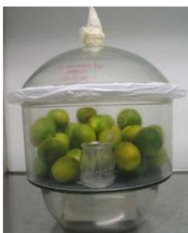
**Figura 5.** Frutos en cámara tratados con 1-MCP. Se muestra en la figura un desecador de 25 L utilizado para la aplicación tanto de 1-MCP como de etileno.
