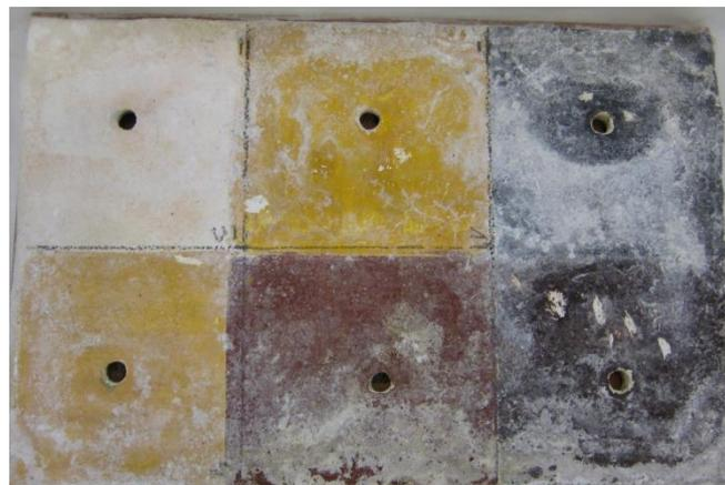
**Figura 4.** Imagen de la probeta 2 con eflorescencias salinas en su superficie
