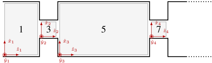
Figura 5.9: Regiones donde se calcula el campo en el filtro de cavidades metálicas.
