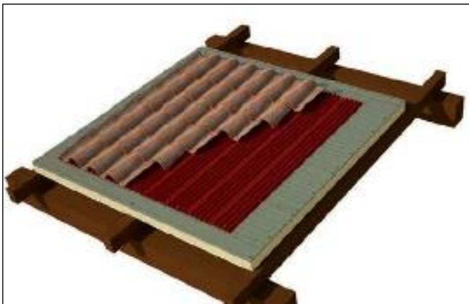
Ilustración 72 Panel sándwich. [www.panelsandwich.org](http://www.panelsandwich.org)
