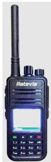
Figura 3.4: Radio DMR Retevis con firmware modificado para escanear DMR
