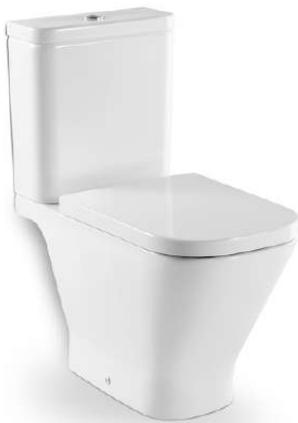
Pack inodoro completo de tanque bajo compuesto por taza con salida horizontal, tanque de alimentación inferior con mecanismo de alimentación y mecanismo de doble descarga 4,5/3L, tapa y asiento con caída amortiguada.
