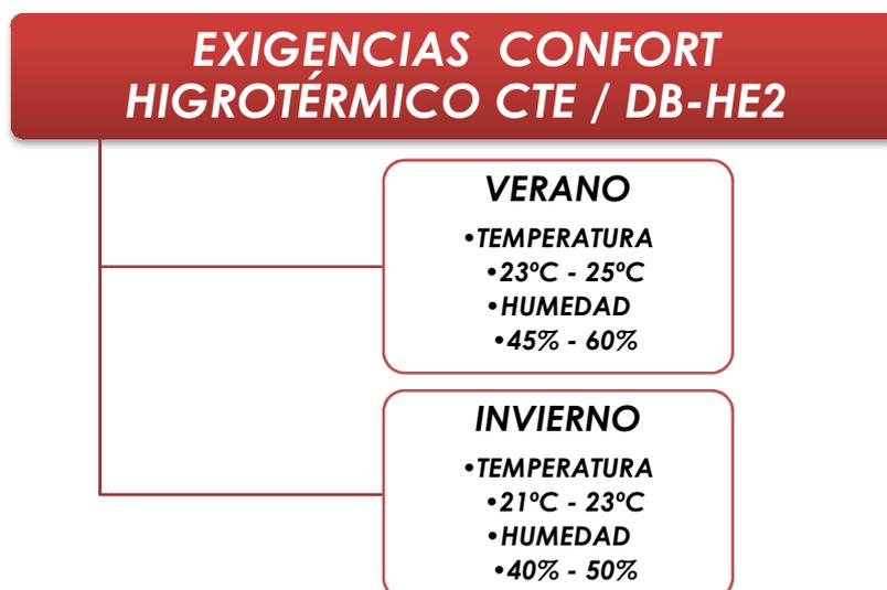
Figura 3.2. Confort Higrotérmico – Fuente: C.T.E. DB-HE2
