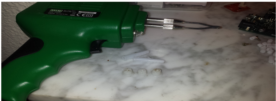
Figura 4.2: Reciclado y deformación de cilindros de plástico para porta-tornillos
