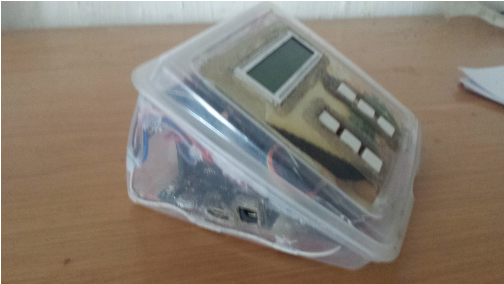
Figura 4.5: Teslametro con Arduino y reciclaje de desechos plásticos
