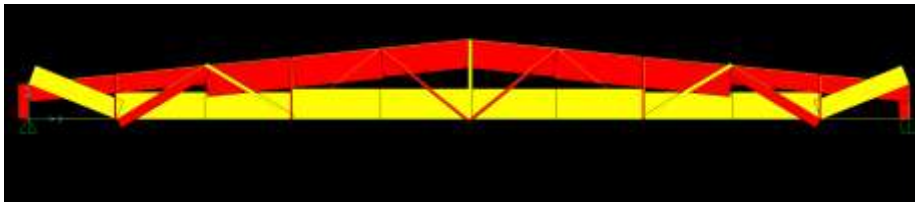
Figura 15: Tipo de esfuerzo calculado mediante SAP2000 (kg)
