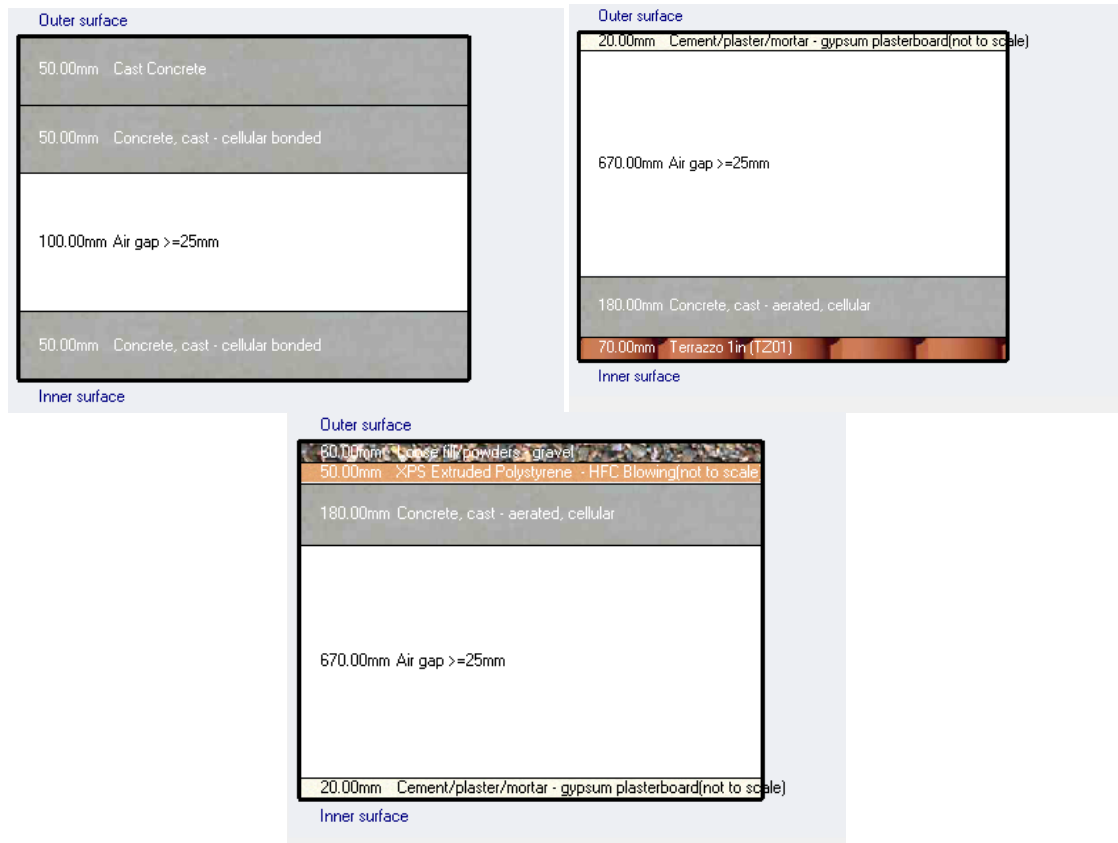
Ilustración 42. Composición de los muros exteriores (izquierda), suelos interiores (derecha) y cubierta plana (abajo) sin capa aislante
