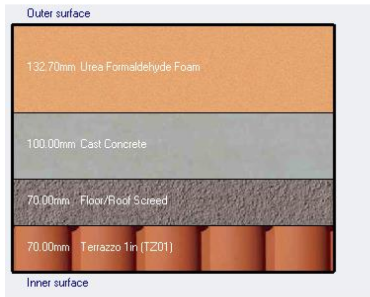
Ilustración 20. Composición del suelo con el terreno
