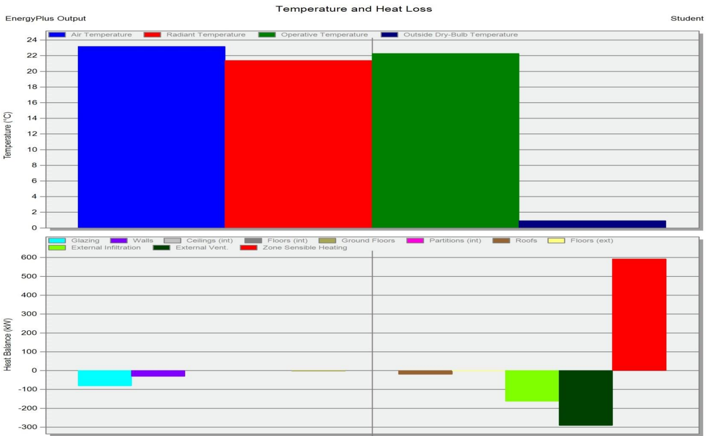
Ilustración 39. Pérdidas de calor en el día de diseño de invierno. Caso base
