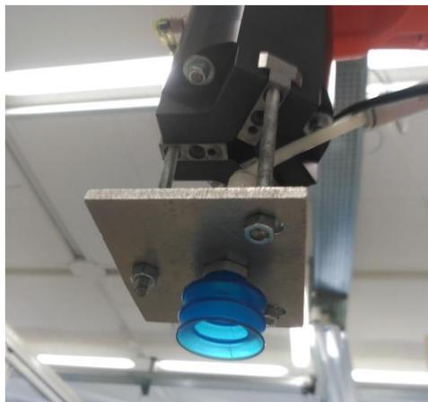
**Figura 9. Ventosa conectada al brazo robot.**
