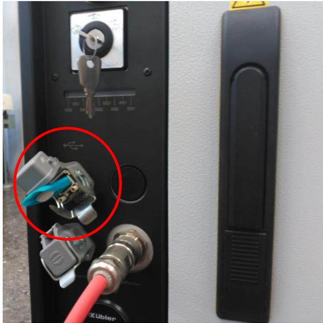
Imagen 7. Memoria USB conectada a la unidad de control del robot.
