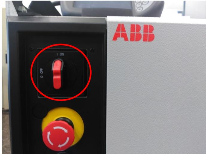
**Imagen 5. Interruptor de encendido/apagado de la unidad de control.**
