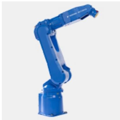
**Figura 4. Robot industrial MH5LS II/MH5LF de la marca Motoman.**
