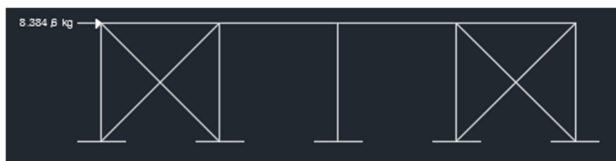
Imagen 35 Esquematización de los esfuerzos en los arriostramientos de la fachada OESTE
