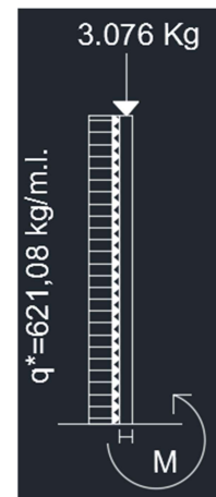
Imagen 18 Esfuerzos en el pilar
