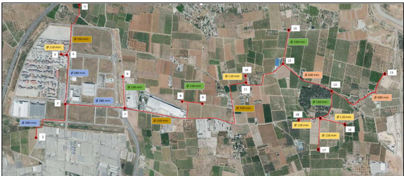
Ilustración 4. Detalle de la red de riego y los puntos de suministro
