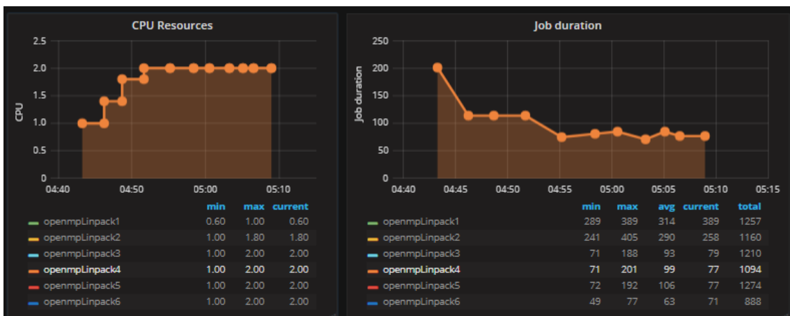
Figura 25: Valor de CPU asignado en cada iteración y duración de cada iteración de la aplicación openmpLinpack4.
