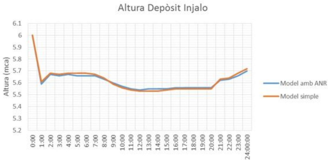
Gràfic 14. Altura dipòsit Injalo, Chakvi en funcionament.
