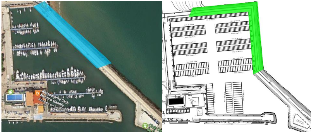
Tramo de dique a demoler Nuevo tramo de dique [PROYECTO]
