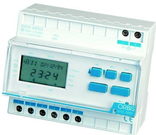
Fig. 3.4.4.6: el reloj astronómico (interruptor horario) calcula automáticamente la hora de salida y de puesta del sol en función de la posición geográfica en la que está ubicado. Esto permite ahorrar energía eléctrica que alimenta el alumbrado del puerto.
