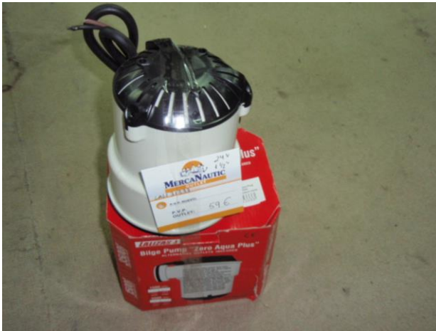
Fig.3.4.4.3: bomba para el achique de aguas de sentina. Conviene llevar un registro del vaciado de las aguas de sentina, ya que los usuarios pueden optar por liberar las sentinas en alta mar de manera ilegal y perjudicial para el medio marino.
