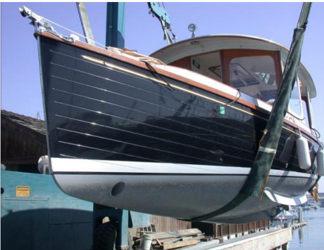
Fig. 3.4.4.5: la pintura de Resina Epoxídica-Cerámica está libre de sustancias tóxicas para el medio ambiente y proporciona al casco un revestimiento duro, brillante y resistente.
