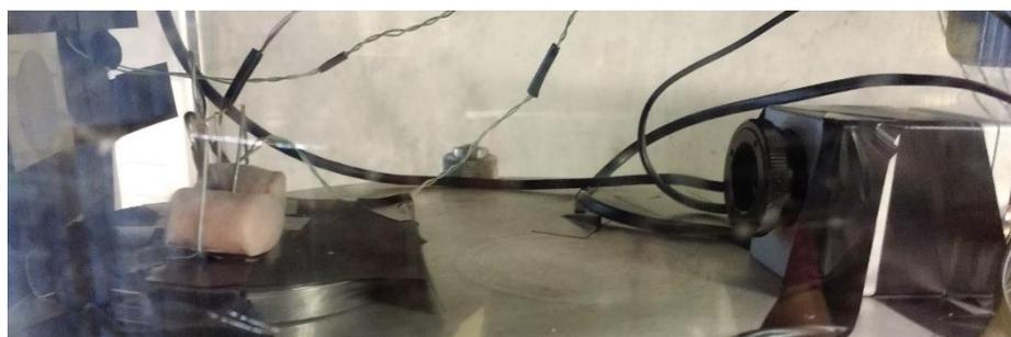
**FIGURA 3.** Cámara termográfica enfocando a las muestras.
