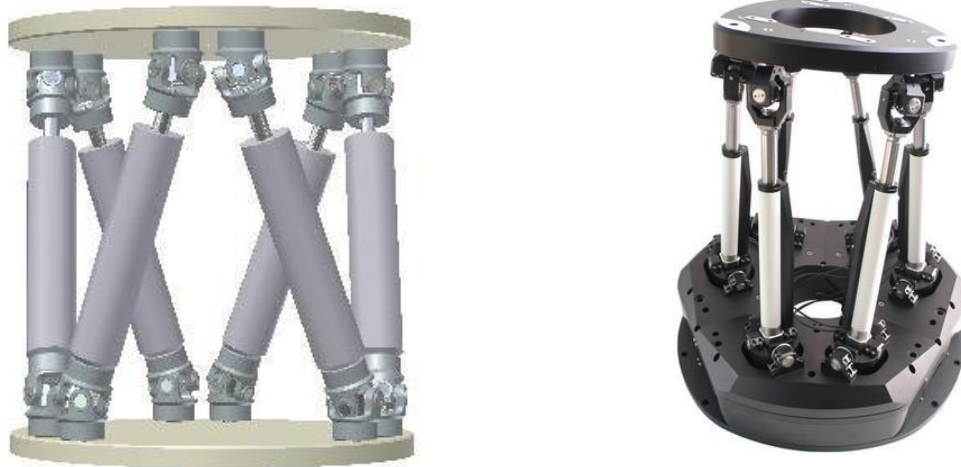
Fig.9 i 10. Esquema i foto d'una plataforma Stewart
