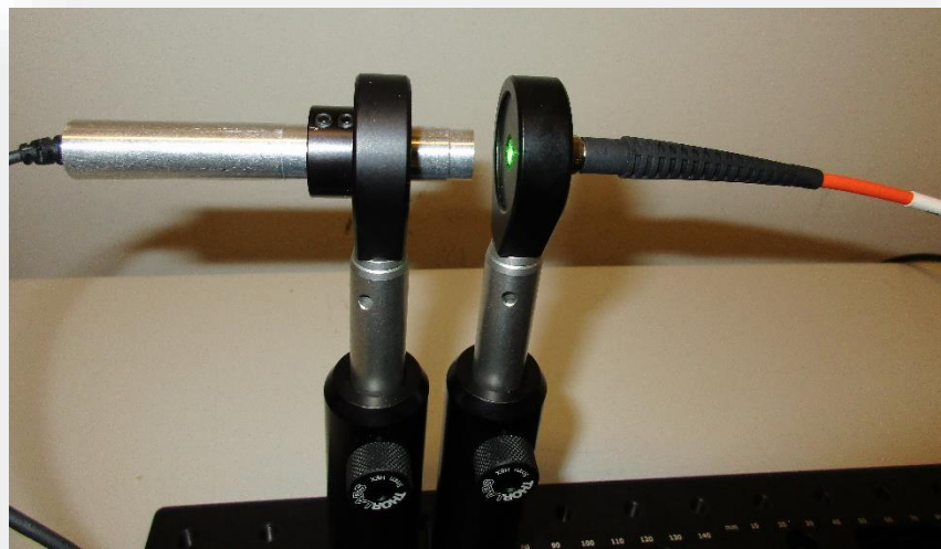
Figura 58. Sistema d'espectrofotometria preliminar. Foto del muntatge en detall (II). Font: pròpia.
