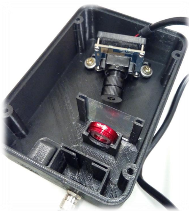
Figura 199. Muntatge del sistema òptic del mòdul bàsic. Font: Pròpia.
