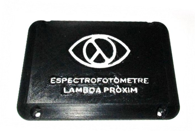
Figura 204. Tapa del model desenvolupat impresa. Font: Pròpia.
