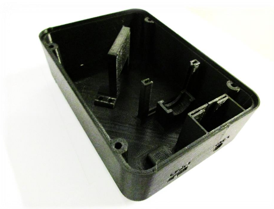
Figura 193. Suport de la càmera dissenyat per la nova caixa del model desenvolupat. Font: Pròpia.
