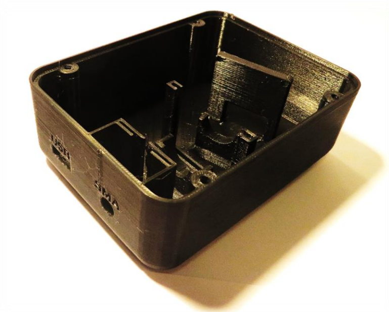
Figura 189. Disseny de la caixa del mòdul desenvolupat imprès en una sola peça. Font: Pròpia.
