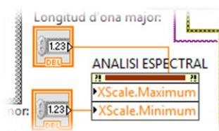
Figura 97. Aplicació de les variables de longitud d'ona major i menor al gràfic de la GUI, zona ampliada. Font: Pròpia.
