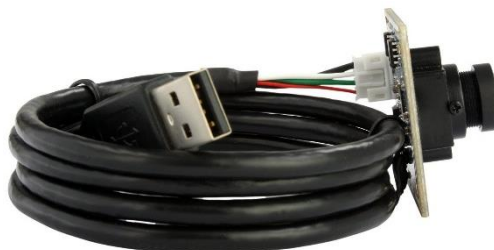
Figura 47. Càmera seleccionada, tamany en comparació al connector USB. Font: ELPCCCTV.
