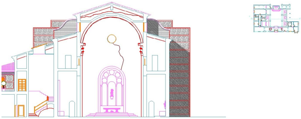
Imagen 42. Plano grietas interior altar. Fuente: plano propio.
