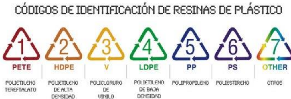
Figura 47: Distintos tipos de termoplásticos
