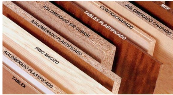
Figura 25: Tipos de maderas artificiales
