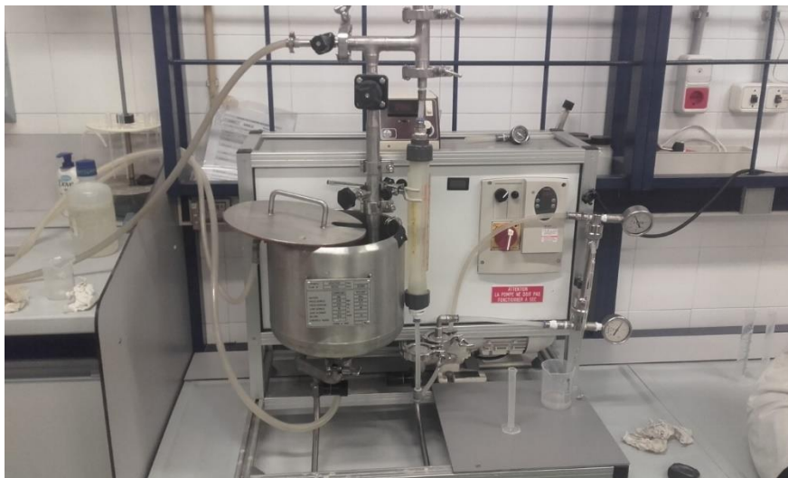
Figura 10. Planta piloto de ultrafiltración
