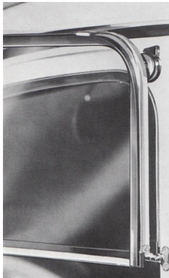
Figura 2-15: Sistema de anclaje en las ventanillas laterales del 2CV. Ref 15]
