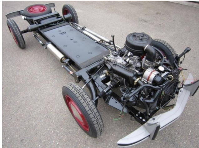
Figura 5-11. Suspensión del Citroën 2CV. Ref [24]
