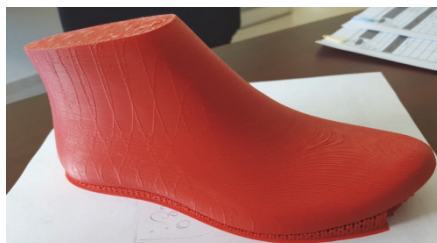
Fig.10 Horma impresa en 3D. Fuente: Elaboración propia (2016)
