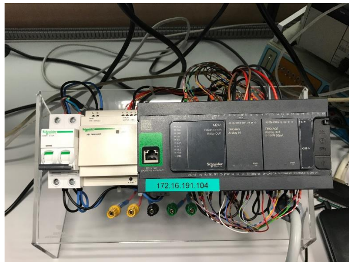
Ilustración 2: PLC Schneider Modicon M241 (Fuente: Elaboración propia)
