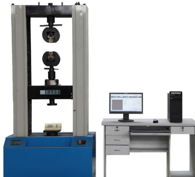
Figura 17: Ejemplo de máquina de ensayos universal de tracción-compresión. Fotografía obtenida de la web Testersupply.es
