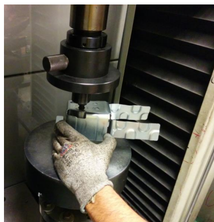
Figura 18: Ejemplo de ensayo de tracción en la máquina de ensayos universal. Fotografía elaborada por el autor del TFM.
