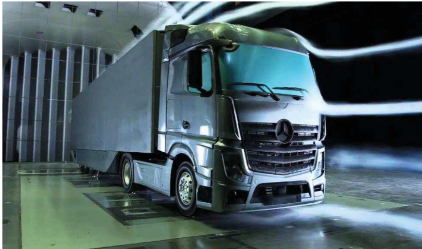
Figura 6. Prototipo de Mercedes con la cabina Actros y caja aerodinámica. Fuente: www.mercedes-benz.com
