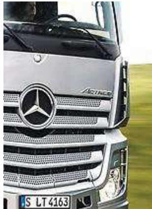
Figura 58. "Turning Vanes" en el lateral de la cabina del nuevo Mercedes - Benz Actros 2017. Fuente www.daimler.com
