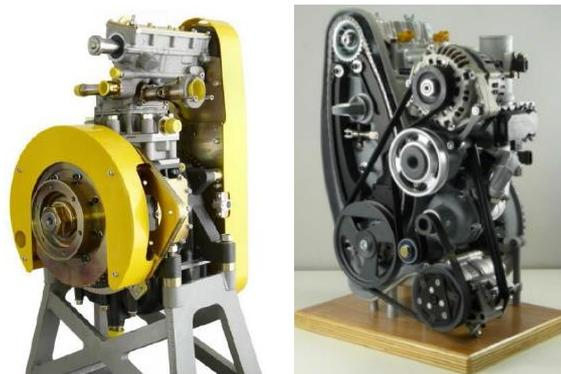
Figura 3.1: A la izquierda fotografía del prototipo monocilíndrico, a la derecha fotografía del motor ULCGE bicilíndrico de serie
