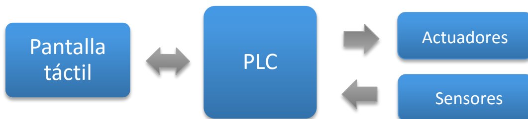
FIGURA 5-1 INTERACCIÓN DE LOS ELEMENTOS DE CONTROL
