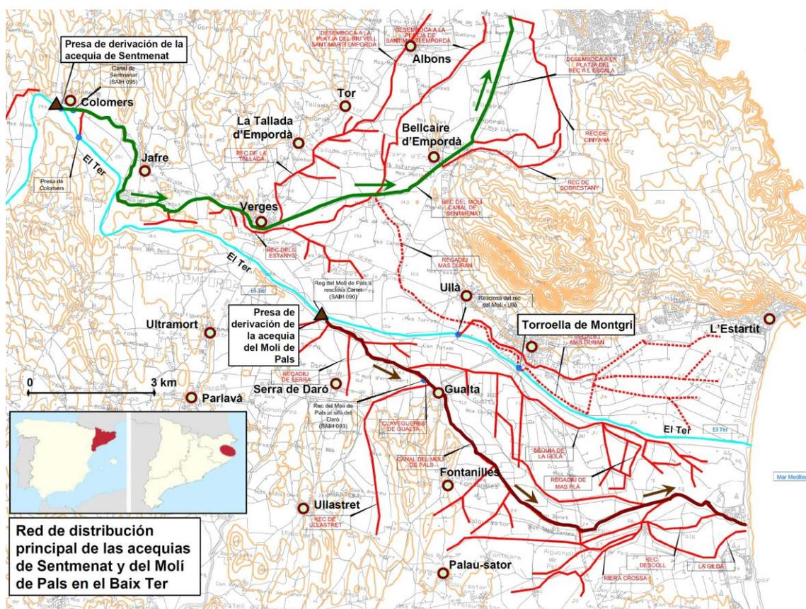
Fig. 2. Trazado de las acequias de Sentmenat y del Molí de Pals así como sus ramificaciones<sup>2</sup>
