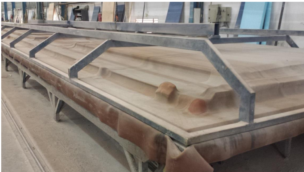
Imagen 45. Lona bajada e inicio de la fase de prensado.
