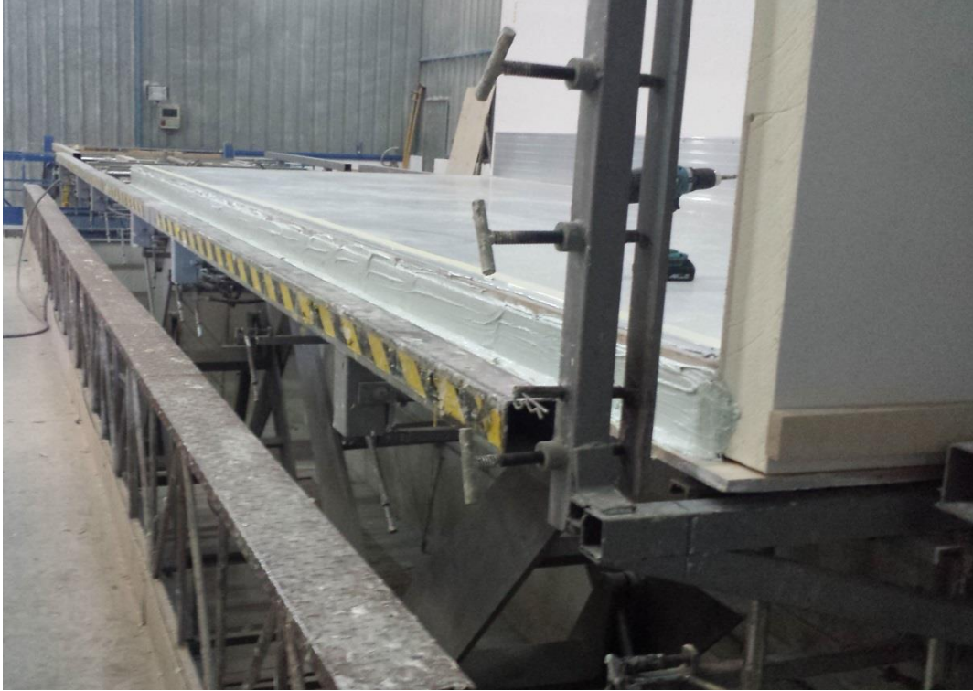
Imagen 48. Ensamblado del segundo lateral.
