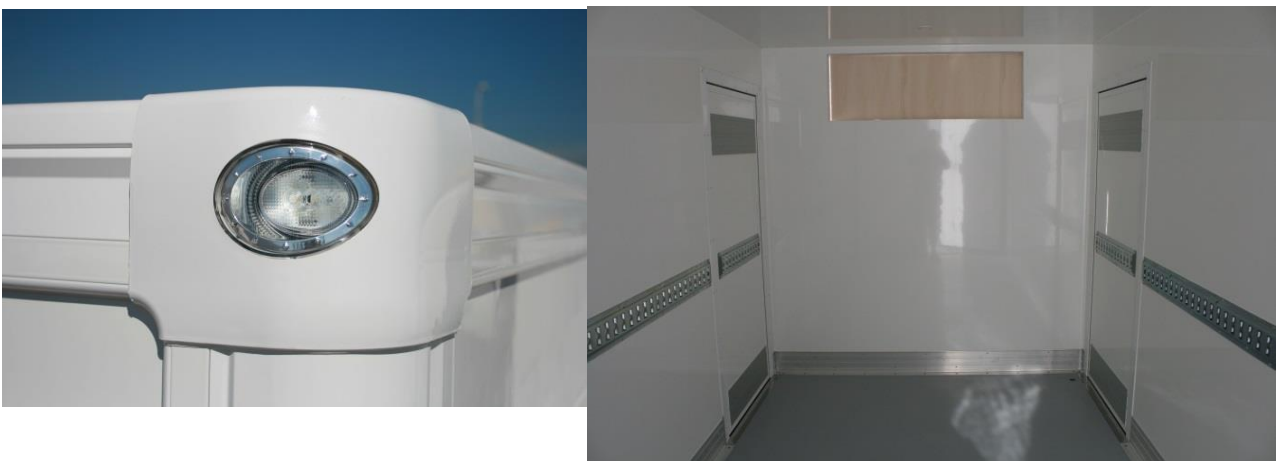
Imagen 54. Fotografías de los accesorios. Piloto de gálibo delantero e interior del furgón.
