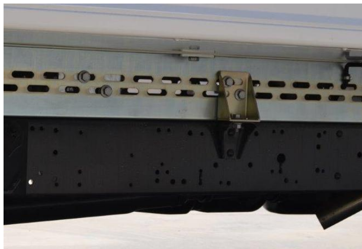
Imagen 56. Detalle del anclaje entre bastidor y sobrechasis.
