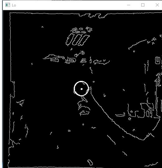
*Fig. 9. Resultados de la detección de círculos sobre bordes detectados.*
