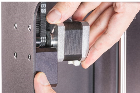
(a) Motor paso a paso con polea dentada y correa
