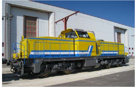
Figura 6. Locomotora de maniobras. Fuente: Stadler Rail Valencia
