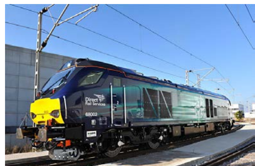
Figura 4. Locomotora Diésel-Eléctrica. Fuente: Stadler Rail Valencia
