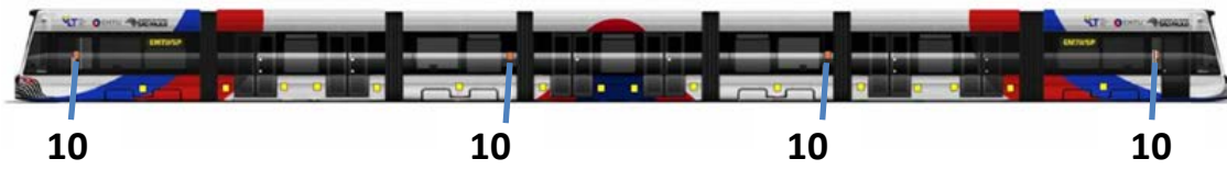
Figura 14. Luces laterales del vehículo. Fuente: Documentos internos Stadler Rail Valencia S.A.U.
