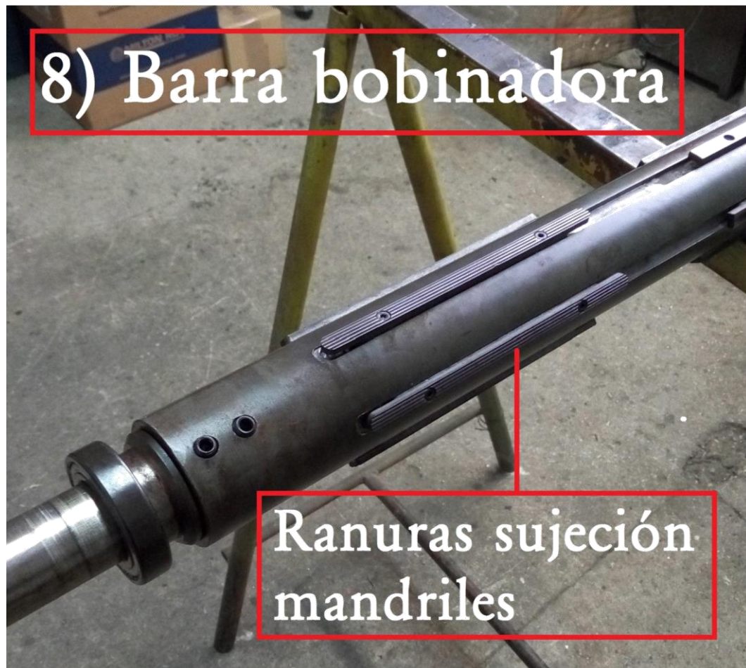
Fotografía 28. "Barra bobinadora (neumática)"
