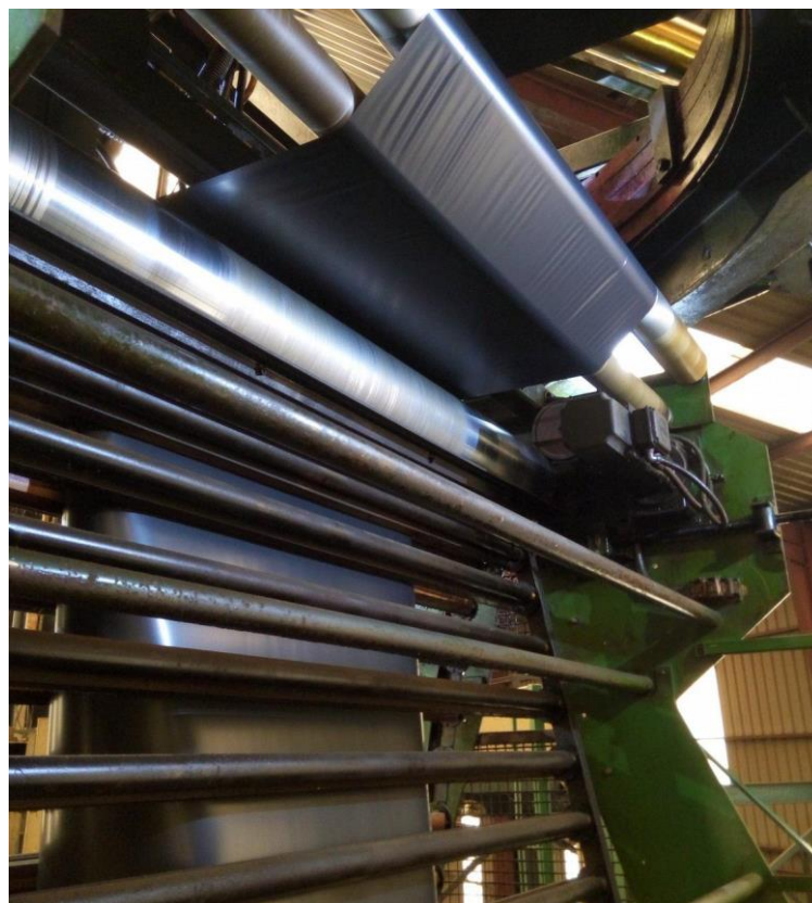
Fotografía 15. "Sistema de aplanamiento"
