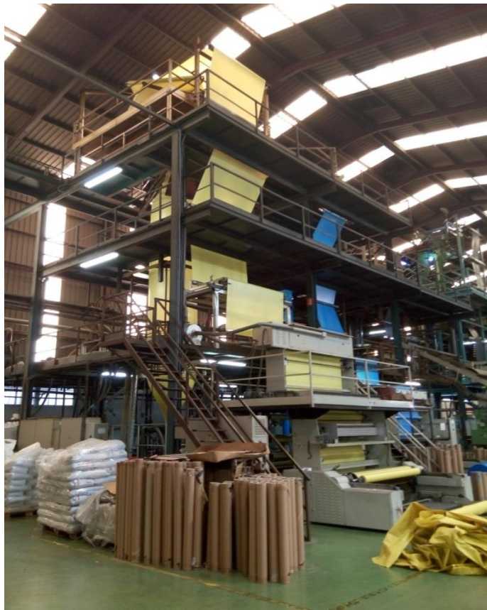
Figura 1.15 – Proceso de extrusión, soplado, calandrado y bobinado final
