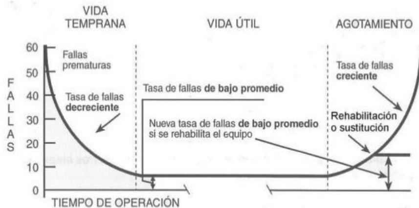
Figura 2.2 – Curva de bañera en los diferentes tipos de fallas.
