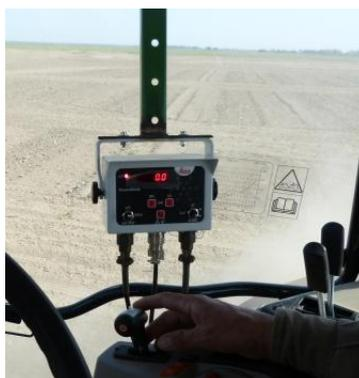
*Ilustración 30: Panel de control manual/automático(<http://www.agroservicios.com.ar>).*
