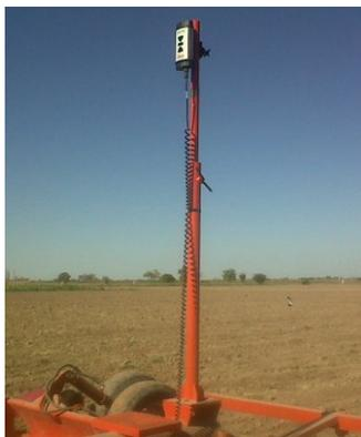
*Ilustración 29: Receptor láser (<http://www.agroservicios.com.ar>).*
