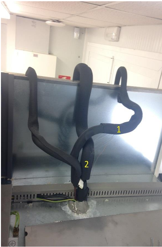
Figura 37 Situación Termopares: 1- Entrada VET; 2- Salida Evaporador; 3- Evaporador
