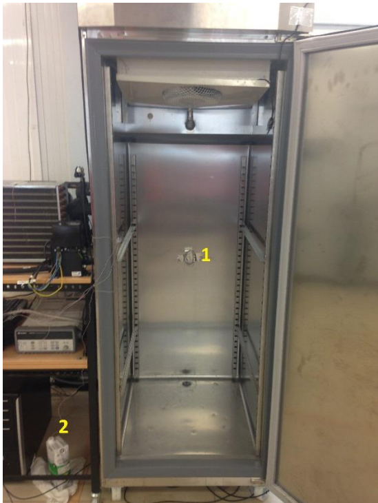
Figura 38 Situación Termopares: 1- Interior del Arcón; 2- Brick de Leche; 3- Entrada Bandeja Drenaje; 4- Salida Bandeja Drenaje
