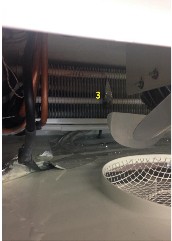
Figura 37 Situación Termopares: 1- Entrada VET; 2- Salida Evaporador; 3- Evaporador
