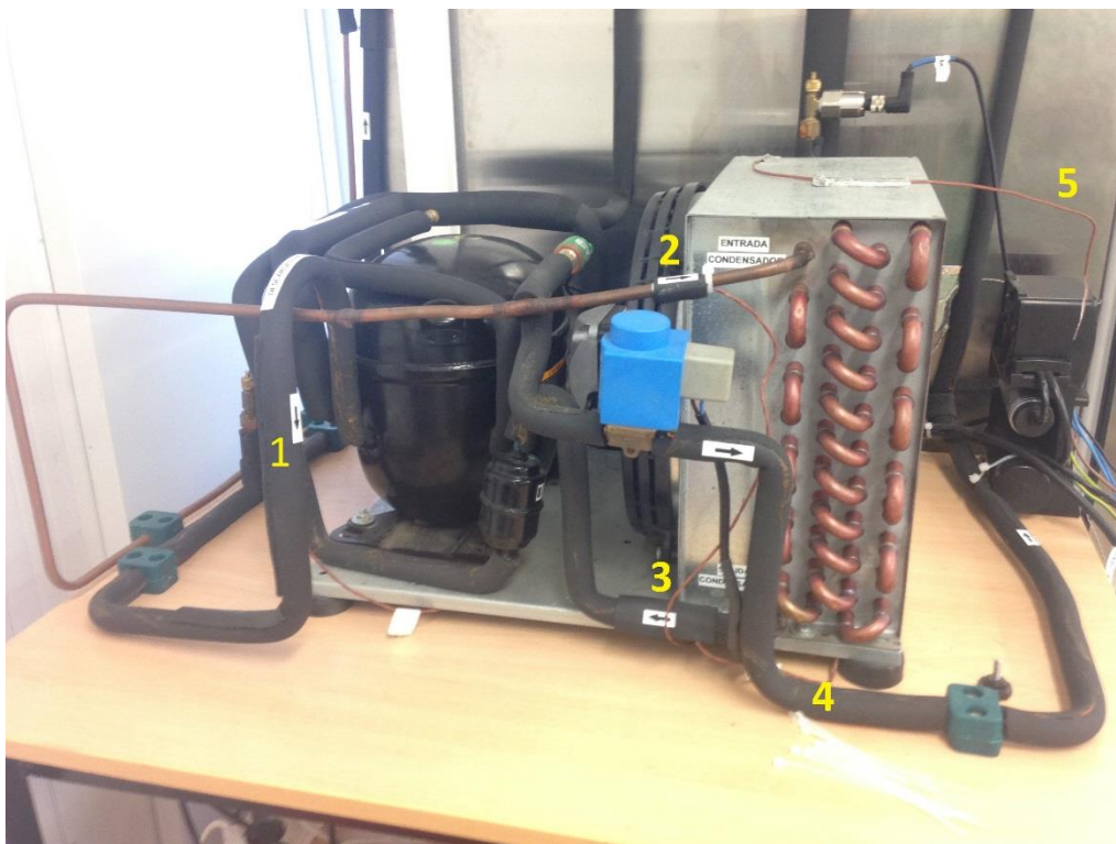
Figura 36 Situación Termopares: 1- Descarga; 2- Entrada Condensador; 3- Salida Condensador; 4- Gas Caliente; 5- Ambiente
