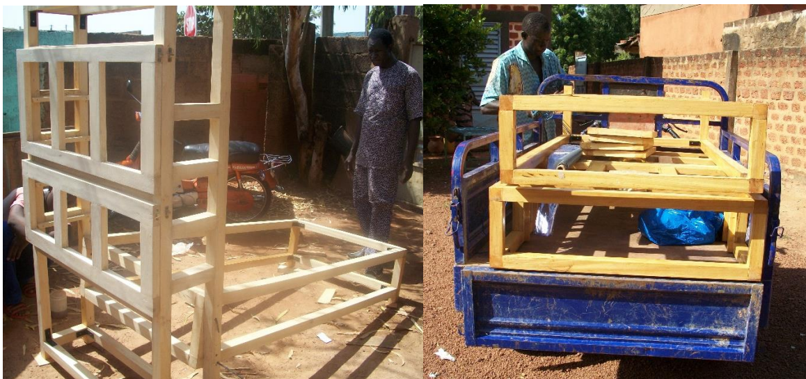
Figura 52. Fases de construcción y transporte de la estructura del deshidratador. Fuente: MÁRQUEZ. M.N.
