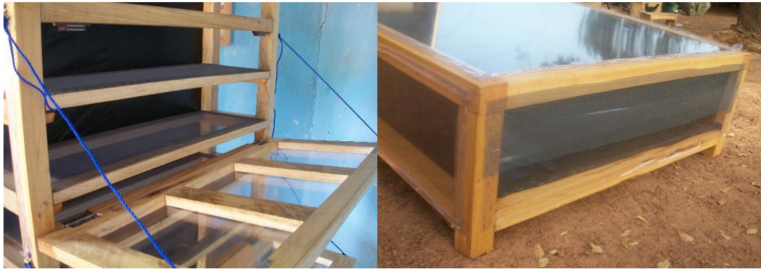
Figura 54. Detalle de las puertas del compartimento de alimentos (izda.) y entrada de aire (dcha.) Fuente: MÁRQUEZ. M.N.
