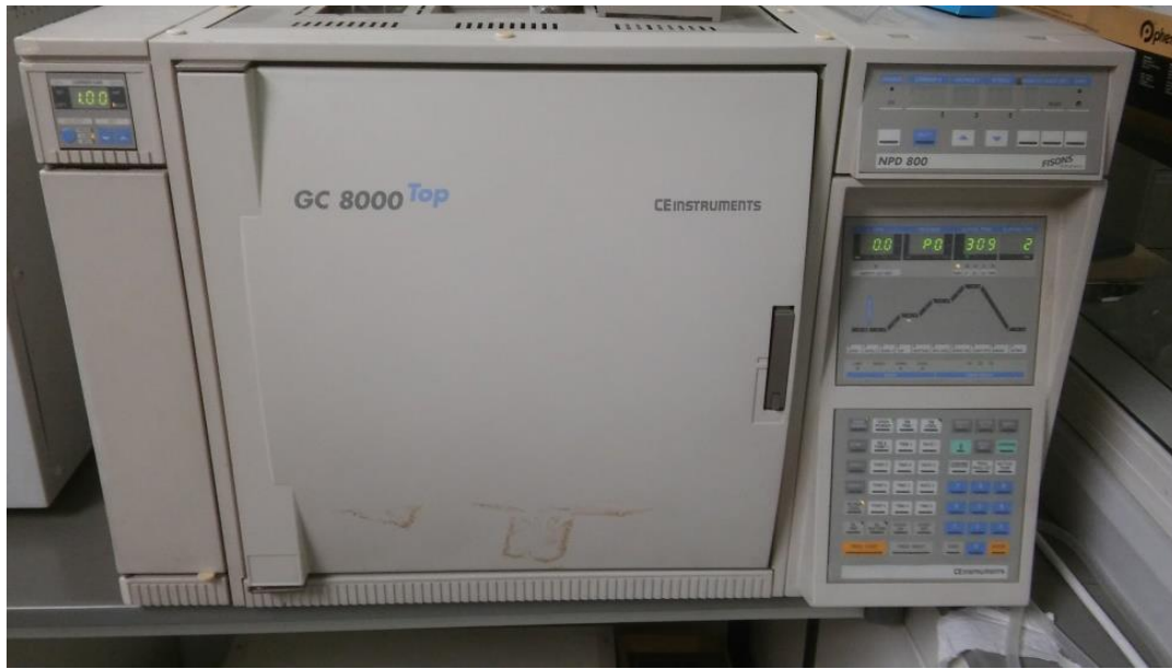
Figura 3. Cromatógrafo de gases GC 8000 Top.
