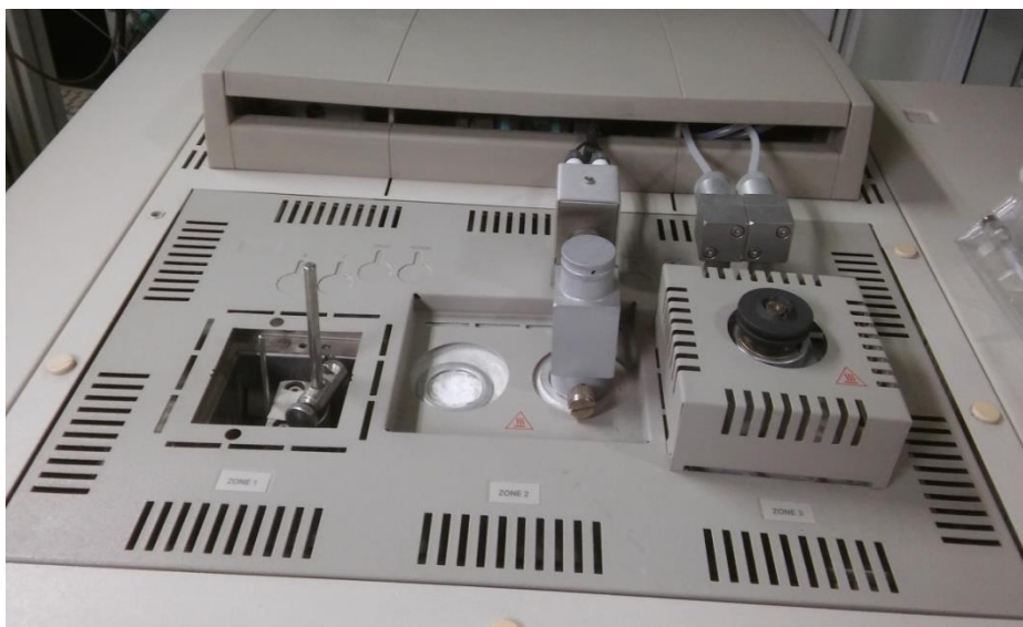
Figura 6. Inyector del GC.
