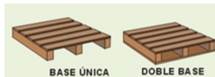
Imagen 14: Palé de piso simple y palé de piso doble.
