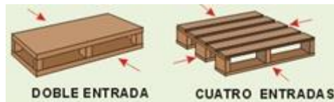
Imagen 11: Palé de entrada doble y palé de cuatro entradas.
