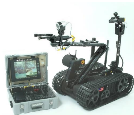
Imagen 31: Robot militar de desactivación de artefactos explosivos.
