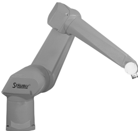
Imagen 94: Robot Staubli TX160L HE.
