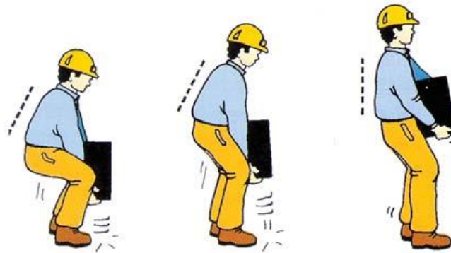
Imagen 104: Dibujo de la manipulación de una carga por un operario.
