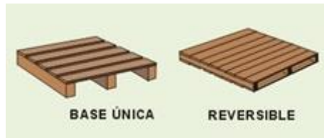
Imagen 12: Palé de una sola cara útil y palé reversible.
