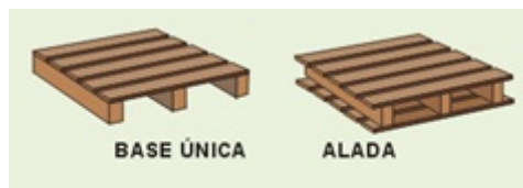
Imagen 13: Palé normal y palé con aletas.
