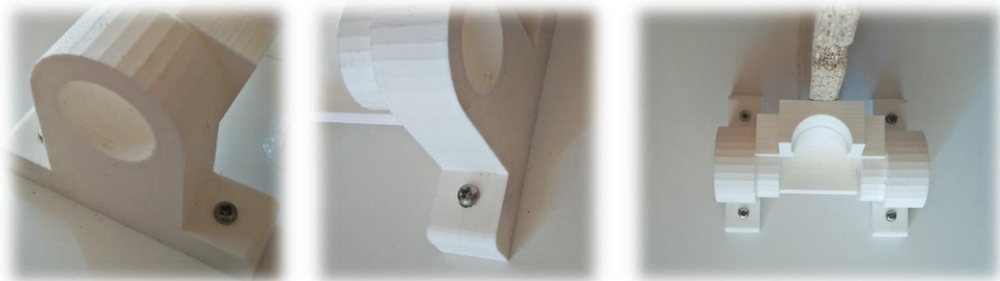
Ilustración 95: Atornillado a la base y verificación ajuste unión T
