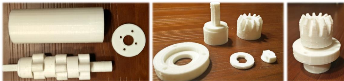
Ilustración 100: Premontaje reductora hipocicloidal
