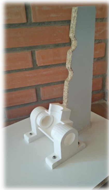
Ilustración 96: Unión soporte perfiles a bancada
