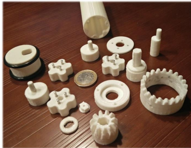
Ilustración 99: Despiece reductora hipocicloidal
