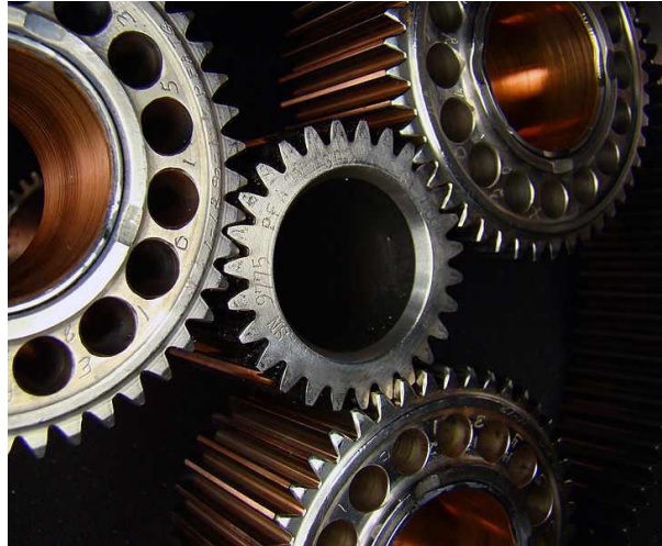
Ilustración 42: Ejemplo engranajes dientes rectos
