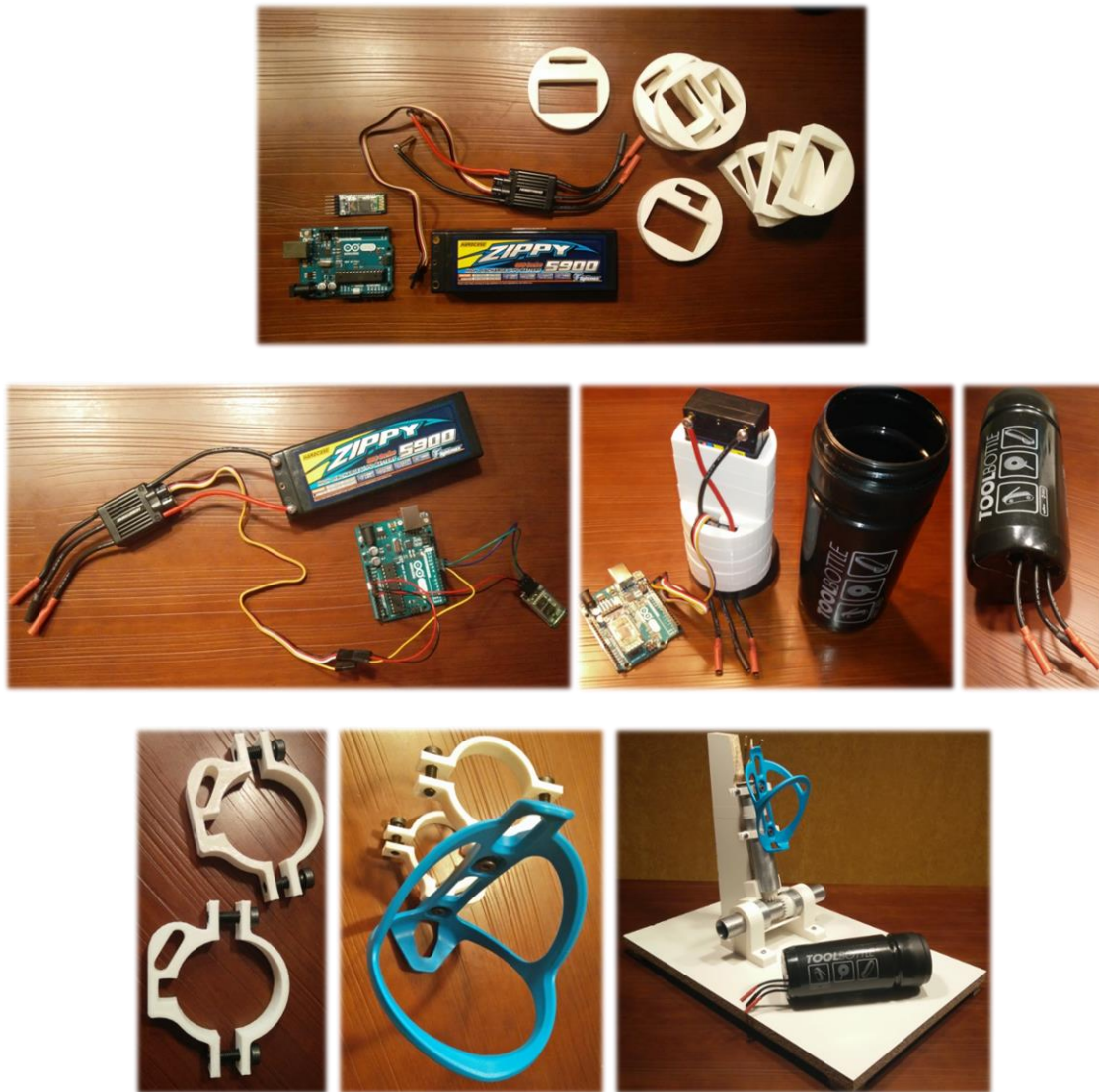
Ilustración 102: Proceso montaje conjunto alimentación y control
