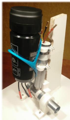
Ilustración 103: Montaje final conjunto alimentación y control
