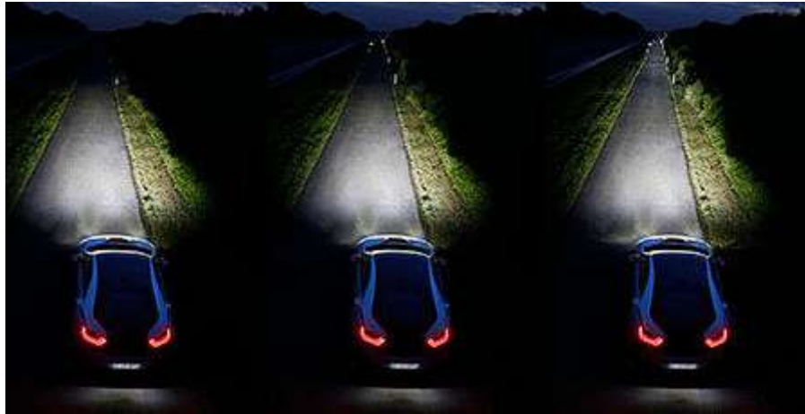
Ilustración 9. Comparativa entre faros halógenos convencionales, xenón y LED.
