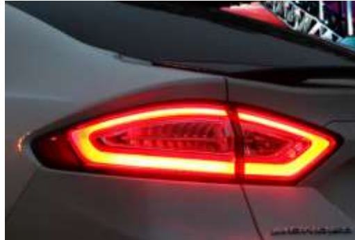
Ilustración 7. Luz trasera tipo LED de un Ford Mondeo
